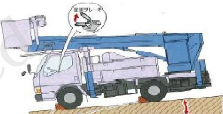
3). アウトリガーを格納するときは、作業床を走行姿勢に戻す。歯止めの位置を確認し、ずれている場合には修正する。会う鳥がの格納は、まず後ジャッキから前ジャッキの順に行う。ジャッキは左右同時に作動する。
