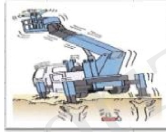
3. 地盤が緩い場所では転倒する可能性が高いです
