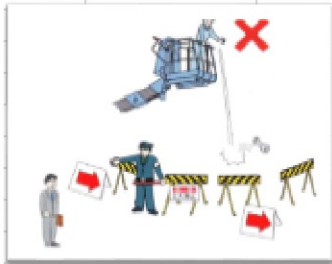
1. 落下物の危険があるので、安全スペースを確保してください
