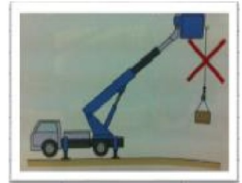
15. 高所作業車は、物を吊り上げるようには設計されていません
