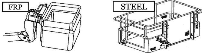
① 高所作業車にはFRPと鉄製のバケットがあります。FRPは耐電圧素材ですが、感電を完璧に防ぐわけではありません。
