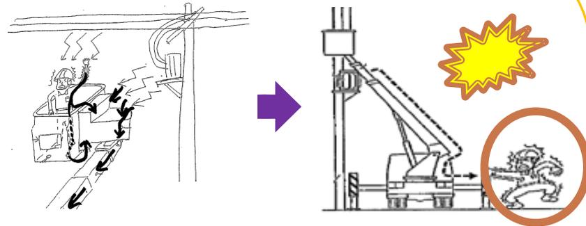
① 高所作業車は直接電線に触れなくても、送電線に近づくことにより車体に電気が溜まります。この時に地上の人が車両に触れたときに感電する場合があります。
