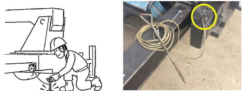
② アース棒を設置することにより、車体に溜まった電気を地面に放電させやすくします。
