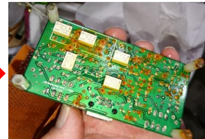
แผงวงจรขึ้นเป็นสนิม
